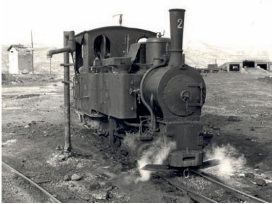
▲ Locomotora n° 2, tipo 020, peso en servicio 10 Tm, presión timbre de trabajo 10 Kg cm 2 , ancho de vías 600 mm. Construida por Orenstein y Koppel – Artur Koppel en Berlín (Alemania) el año 1906 para M.F.U. (Foto: F. Llauradó, marzo de 1966).
